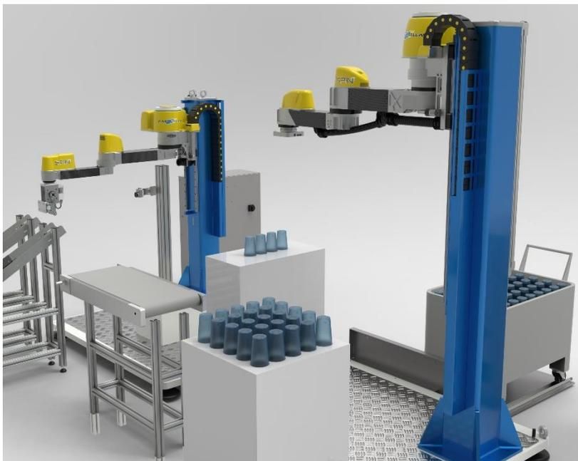
*Un esempio di inscatolamento automatico, una linea con due robot SCARA SPIN Campetella con ridotto ingombro a terra e basso tempo ciclo si occupano dell'estrazione automatica, impilamento e inscatolamento di bicchieri riportanti etichette e grafiche differenti.*
