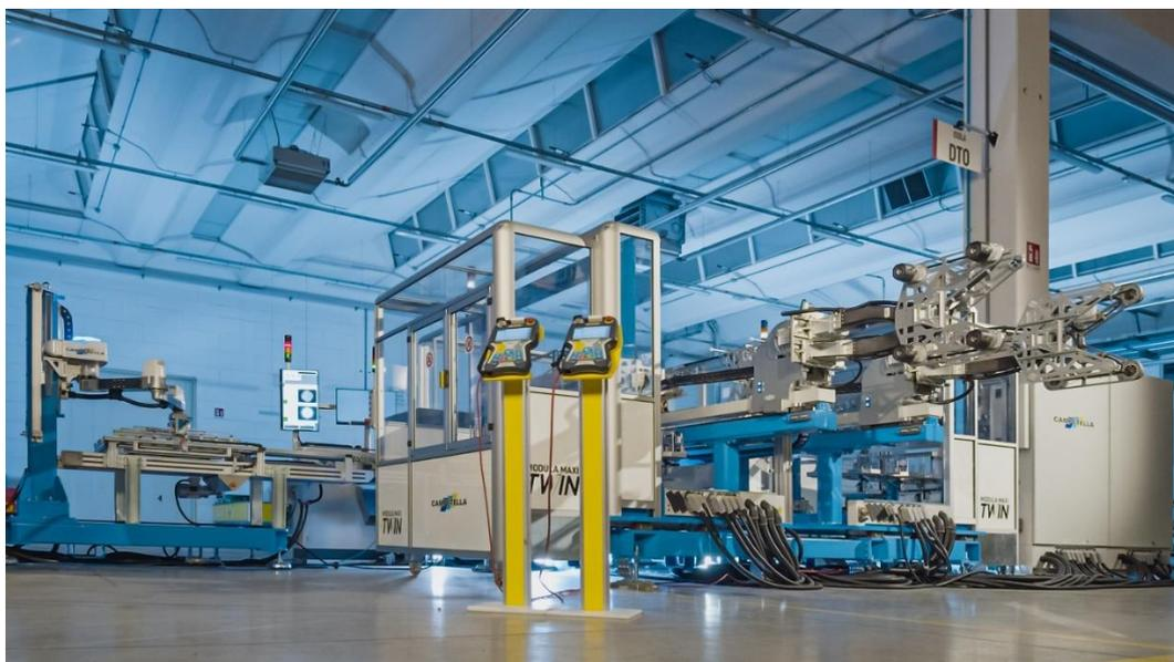
L'imponente Modula Twin Maxi, il robot laterale stack mold progettato per i carichi più pesanti e i più bassi tempi ciclo.
